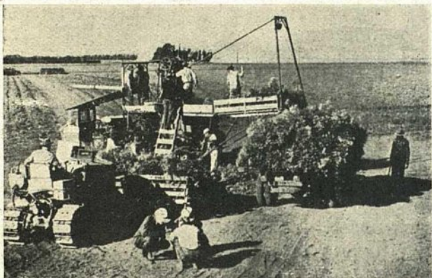
Un rastro movido por un tractor oruga lleva el arbusto a la embaladora. Cuando la bala está hecha, ya está lista para ser llevada a la fábrica.
